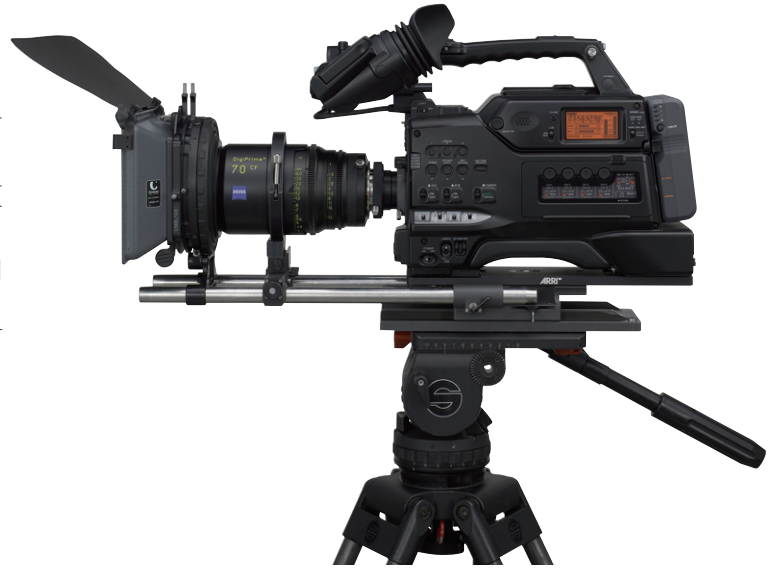
어댑터를 이용하여 HVR-S270N에 시네마 렌즈를 장착한 그림
