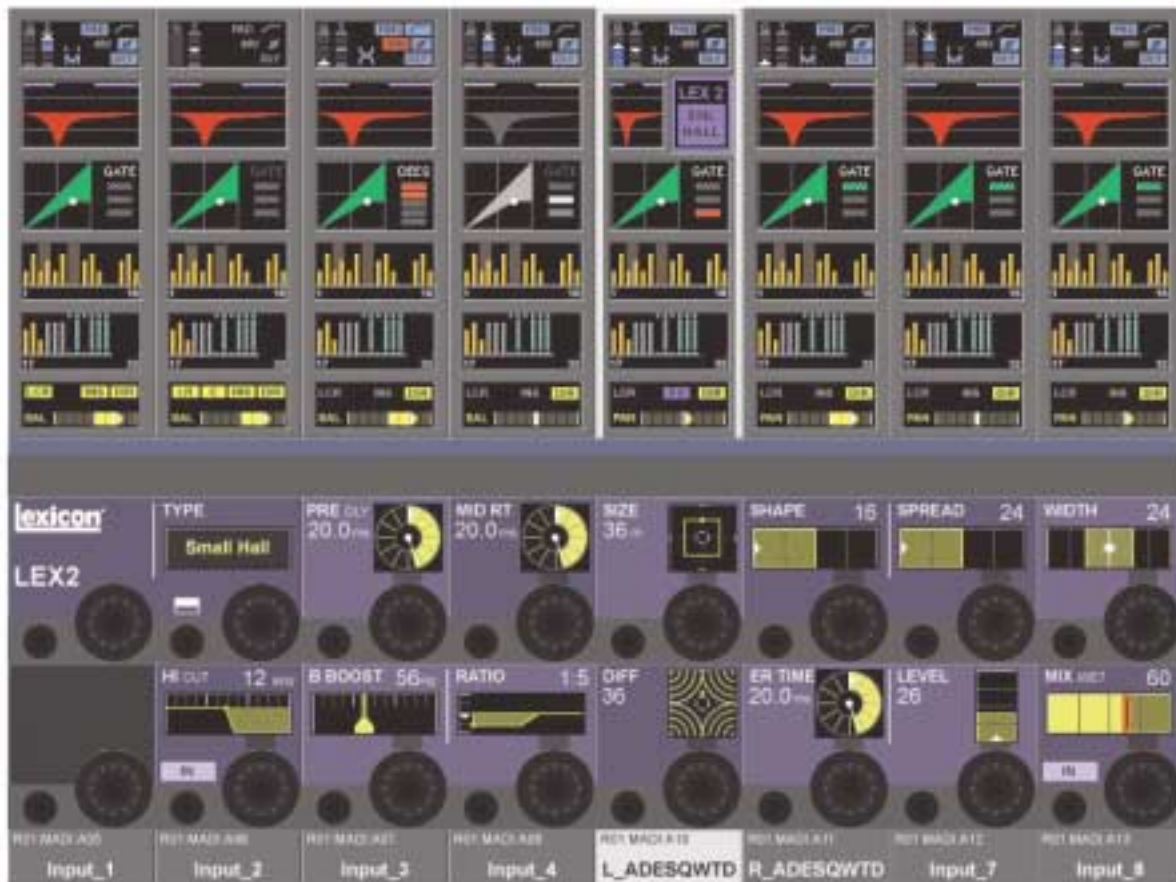
그림 21-6 Adjusting An FX Processor.
