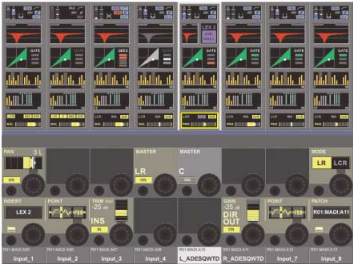
그림 21-5 An FX Processor As An Insert Effect.
