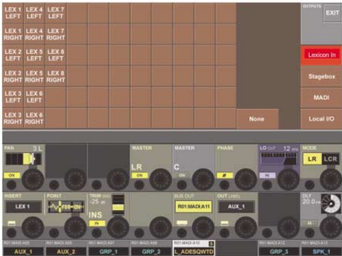
그림 21-11 Patching An FX Processor To A Master Bus Output.
