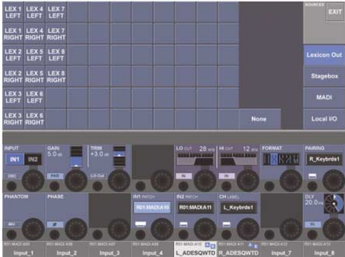
그림 21-12 Patching An FX Processor To An Input Channel's Input.
