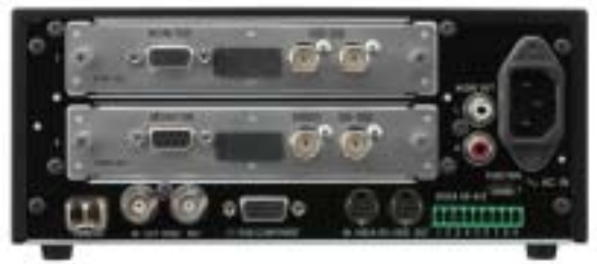
선택사양 HFBK-HD1/HFBK-SD1을 설치한 BRC-H700 후면 패널
